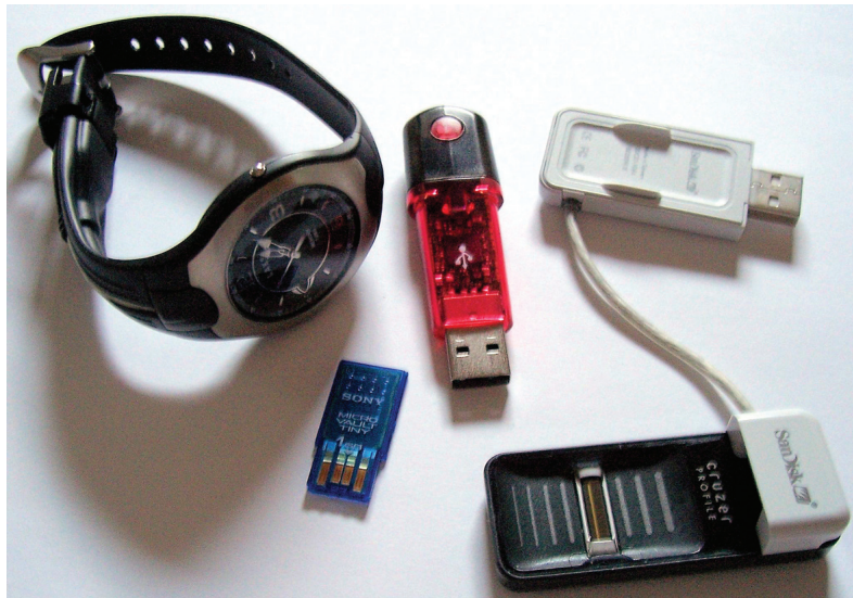
Abbildung 1: USB-Sticks sind heutzutage in verschiedensten Bauformen, als miniaturisierte Varianten oder auch Systeme mit eingebautem Fingerabdruck-scanner erhältlich.
