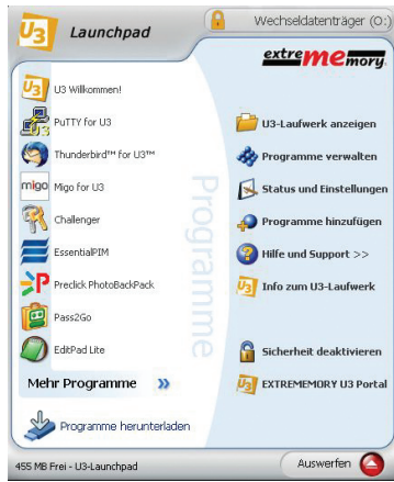
Abbildung 2: So genannte U3-Sticks haben ein eigenes Startmenü und arbeiten als „Mikroplattform“, deren Software keine Installation auf dem Gast-PC erfordert. So lassen sich Softwarebeschränkungen und Installationsverbote eventuell leicht umgehen.
